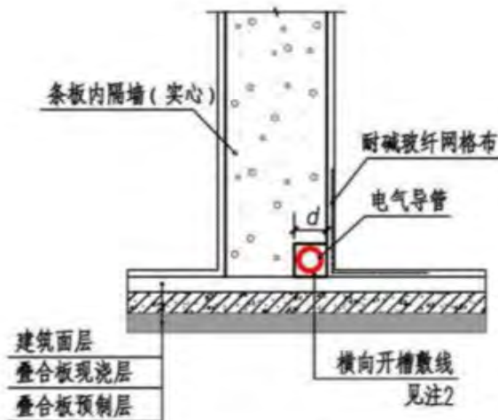
② 电气导管沿内隔墙底部敷设
