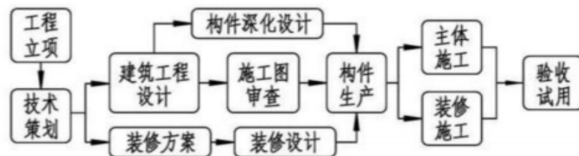
图1 装配式建筑建设流程示意图
