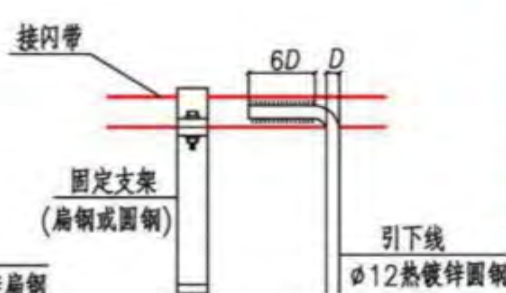
扁钢接闪带与圆钢引下线连接
